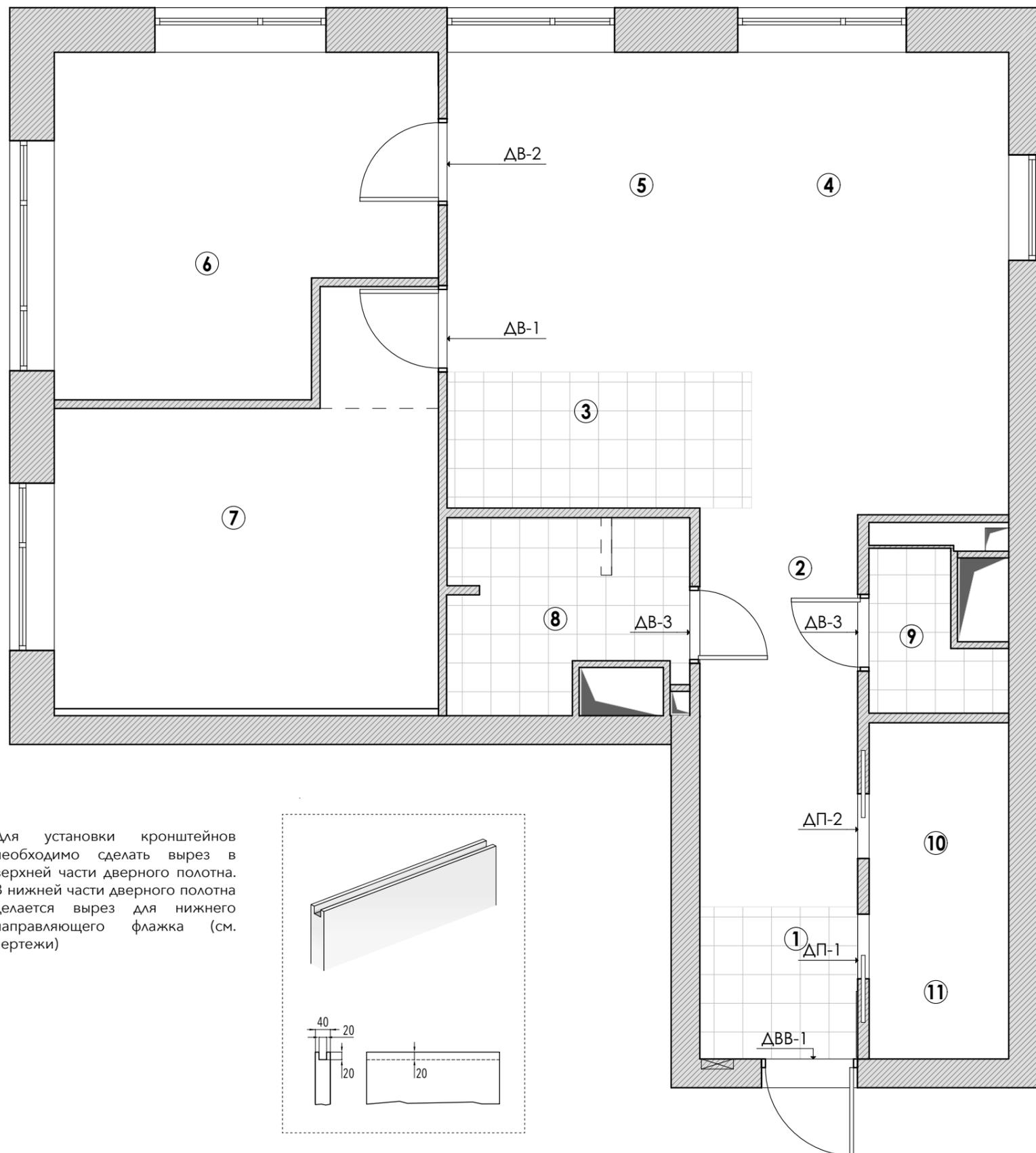
Для установки кронштейнов необходимо сделать вырез в верхней части дверного полотна. В нижней части дверного полотна делается вырез для нижнего направляющего флажка (см. чертежи)
